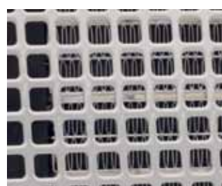
Современный PTC элемент (не сжигает кислород)
