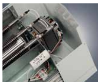
Мощный двигатель на подшипниках качения
