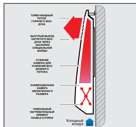
Схема движения воздушного потока
