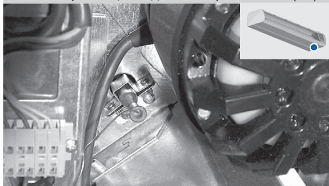
**Рис. 17** – размещение датчика термовентилля (D2)
